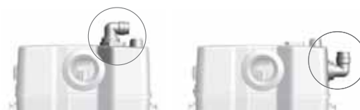
Рис. 16 Горизонтальное или вертикальное расположение напорного патрубка
