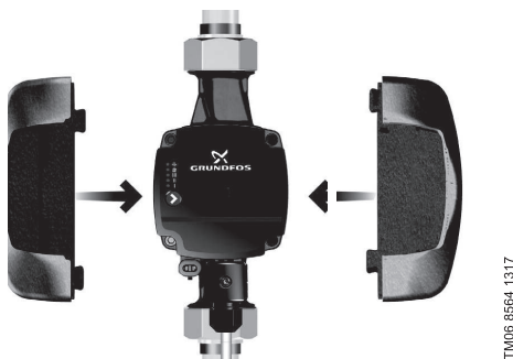
Рис. 7 Установка теплоизолирующего кожуха
