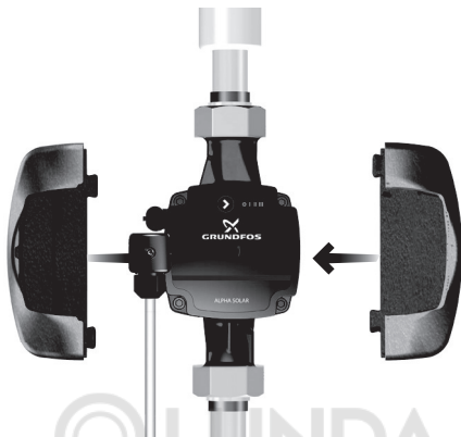
Рис. 8 Установка теплоизолирующего кожуха
