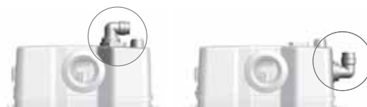
Рис. 8 Горизонтальное или вертикальное расположение напорного патрубка
