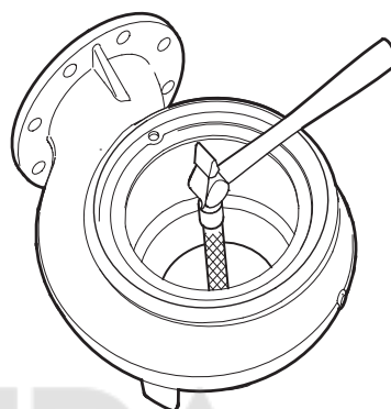
Рис. 21 Монтаж уплотнительного кольца
