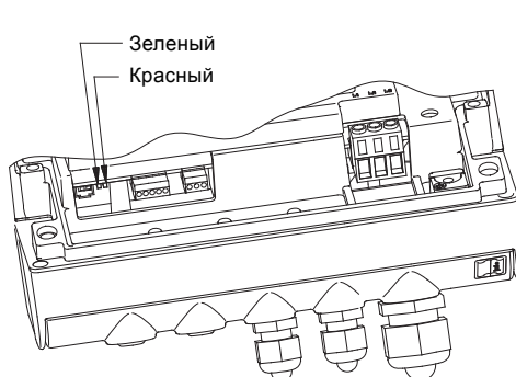
Рис. 37 Световые индикаторы на насосах с однофазными электродвигателями
